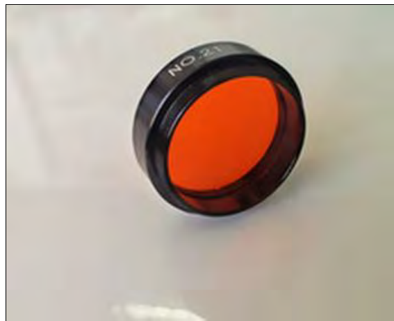
Figure 13: Filtre orange de microscope opératoire
